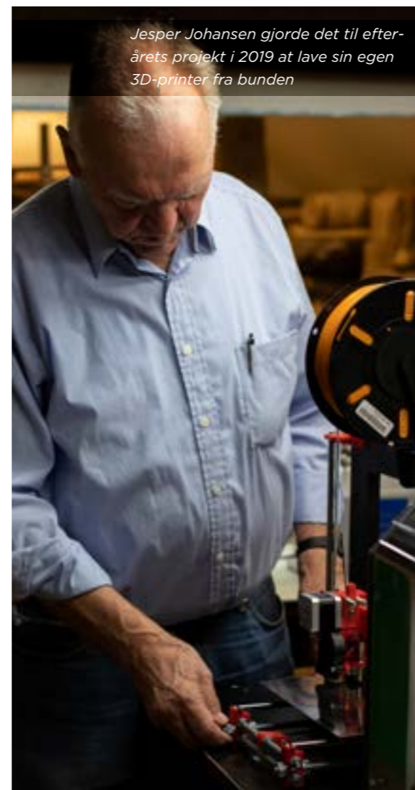
Den hjemmelavede 3D-printer er lavet af 3D-print, træ, tenniske dele fra Kina plus det løse fra det lokale byggemarked.
